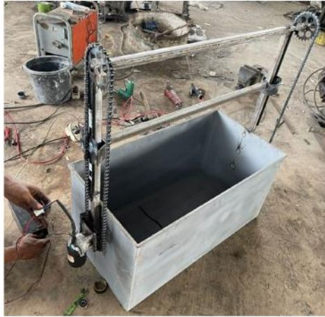
Gambar 2. Alat Automatic Electroplating Chrome untuk finishing produk pande besi
