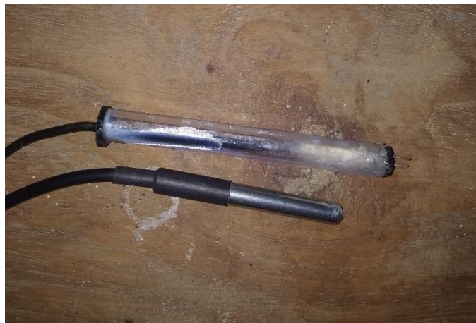
Gambar 5. Bentuk Probe Sensor TDS dan Sensor ds 18b20
