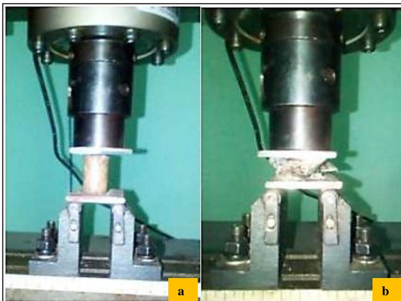
**Gambar 2. Spesimen saat diuji Tekan, (a) Posisi awal sebelum penekanan (uji Tekan), (b) Posisi awal setelah penekanan (uji Tekan)**
