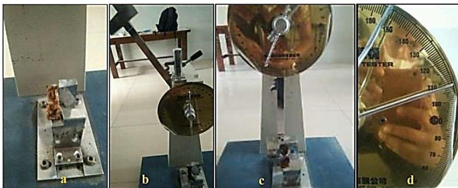
Gambar 1. Spesimen saat diuji Impak *Charpy*; (a) Pemasangan spesimen uji, (b) Posisi awal sebelum penumbukan, (c) Posisi penumbukan spesimen, (d) Skala sudut hasil penumbukan Impak.
