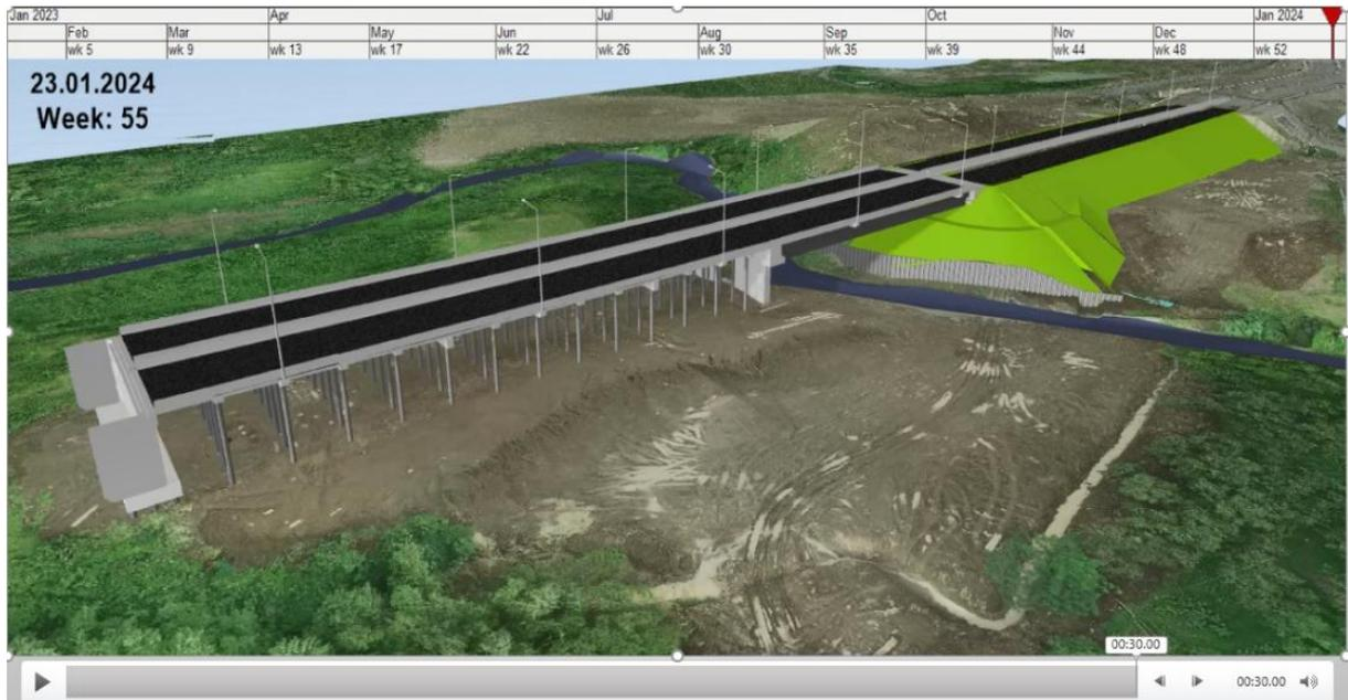
**Gambar 7. Penerapan BIM 4D Menggunakan *Software* Synchro 4D**
